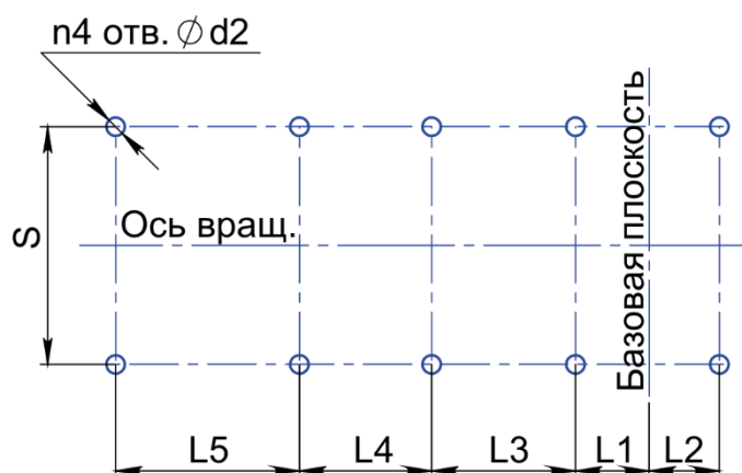
Рисунок 6. Габаритно-присоединительные размеры для вентиляторов, изготовленных по 3 схеме
